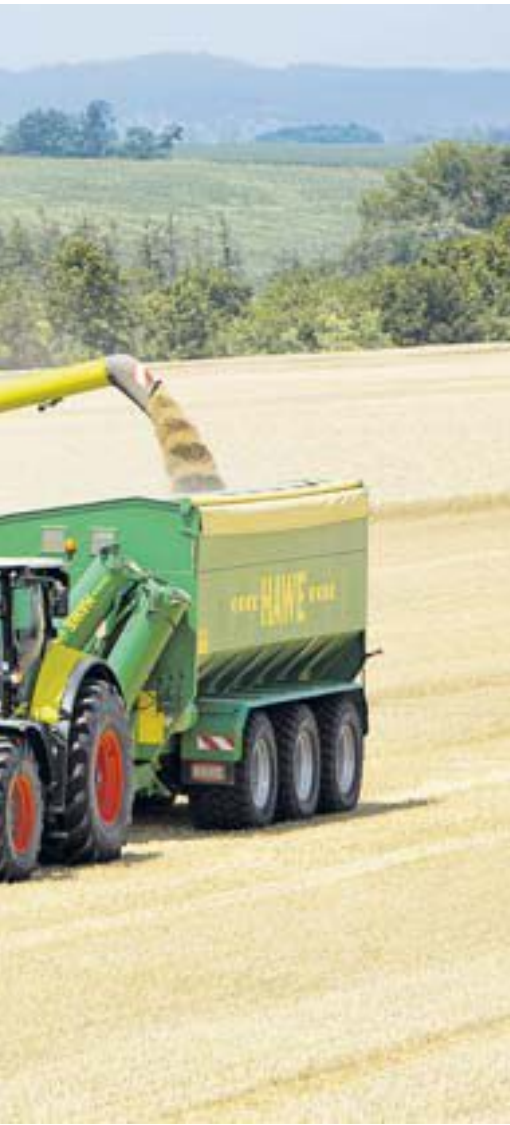
Mähdrescher bei der Ernte: Eine Software steuert, dass ein Traktor und der Mähdrescher parallel fahren.
